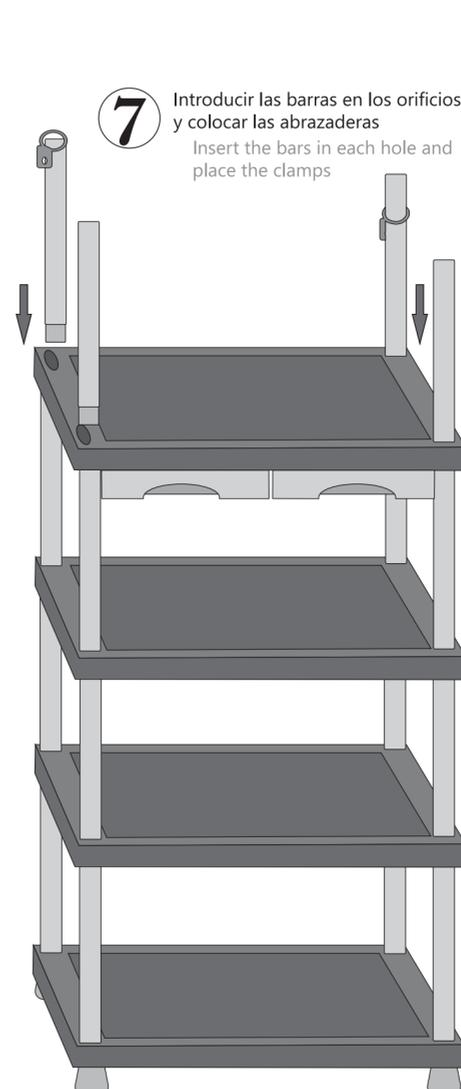
**7** Introducir las barras en los orificios y colocar las abrazaderas
