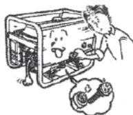
3. En el caso de que el nivel de aceite esté por debajo de la marca de nivel inferior de la varilla, rellene hasta la marca de nivel superior.
