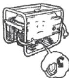
2. Retire el tapón de drenaje y vacíe el aceite de motor existente dentro del cárter
