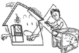
No conecte el generador a un circuito de alimentación doméstico si la alimentación comercial no está cortada.
