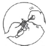
4. Mida la separación de los electrodos
