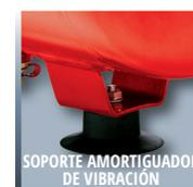
SOPORTE AMORTIGUADOR DE VIBRACIÓN
