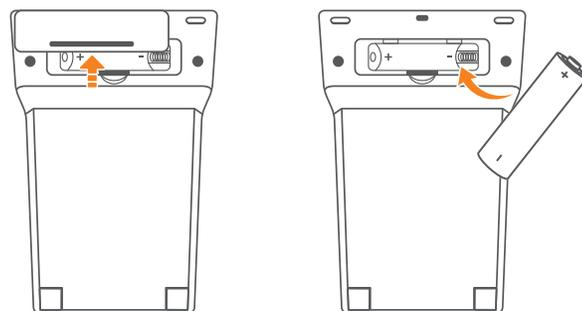
Revisa la polaridad marcada en el compartimento, para colocar correctamente la batería.
