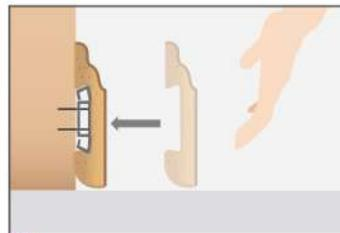
**7.** Presiona el zócalo sobre los clips de fijación hasta que quede firme.
