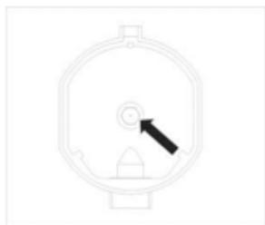
Reemplazo de la boquilla del quemador: afloje la boquilla con una llave especial (7). Monte la nueva boquilla de acuerdo con el tipo de gas requerido (consulte la tabla 1 como referencia).
