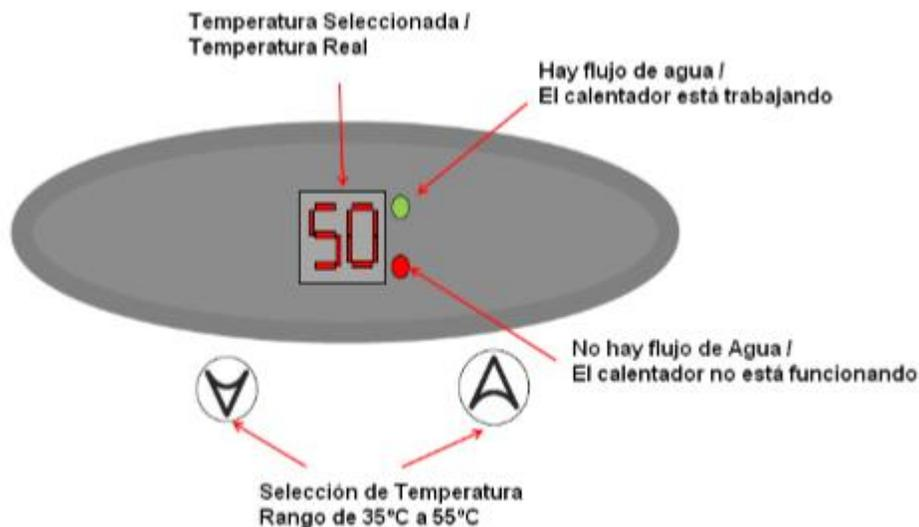
El encendido de la Thermo Master es por medio de flujo, lo cual quiere decir que para que él entre en funcionamiento, necesita estrictamente que el agua este circulando a través del aparato. El caudal mínimo de trabajo para un rendimiento óptimo es de 1,5 L/min.
