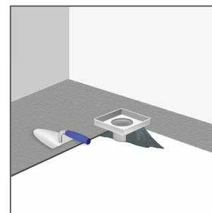
**8.** Extiende la mezcla de concreto hasta llegar al borde inferior de la base del desagüe creando una inclinación de mínimo 2% por metro lineal, en dirección a donde se instalará. Si deseas, instala una membrana impermeabilizante siguiendo las instrucciones del fabricante.
