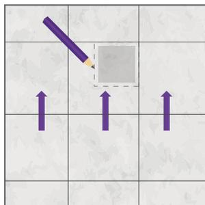
**3.** Presenta el desagüe y marca el contorno en la superficie donde harás la instalación. La profundidad del desagüe total es de 65 mm.
