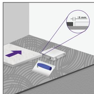
**11.** Coloca los cerámicos dejando +/- 1/4" (5 mm) de junta con el borde de la canaleta. Para garantizar el flujo correcto del desagüe, los cerámicos deberán ubicarse a una altura de 1 mm mayor que la parte superior del desagüe. La instalación puede realizarse con cerámicos de hasta 5/8" de altura (16 mm). Los cantos de los porcelanatos deben quedar biselados. El sellado entre el suelo y el revestimiento debe ser elástico e impermeable.
