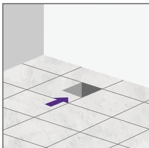
**1.** Determina el lugar donde será instalado el desagüe/coladera cuadrada. La posición en el box de ducha puede ser en el sector posterior, al frente o en el centro.
