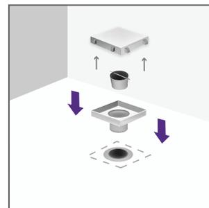
**4.** Conecta el tubo de salida de la base del desagüe con el tubo de desagüe de la ducha, sellando con la silicona impermeable.
