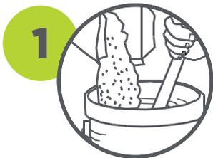
En 4-5 litros de agua limpia agregue gradualmente un saco de (20 kg) de Pegamix EL ORIGINAL mientras mezcla hasta obtener una pasta suave y sin grumos. Espere 10 minutos antes de usar la mezcla.
