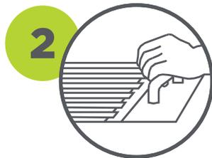
Con el lado liso de una llana metálica aplique una capa de adhesivo sobre la superficie haciendo presión. Aplique más material y peine con la parte dentada de la llana dejando líneas en un solo sentido.
